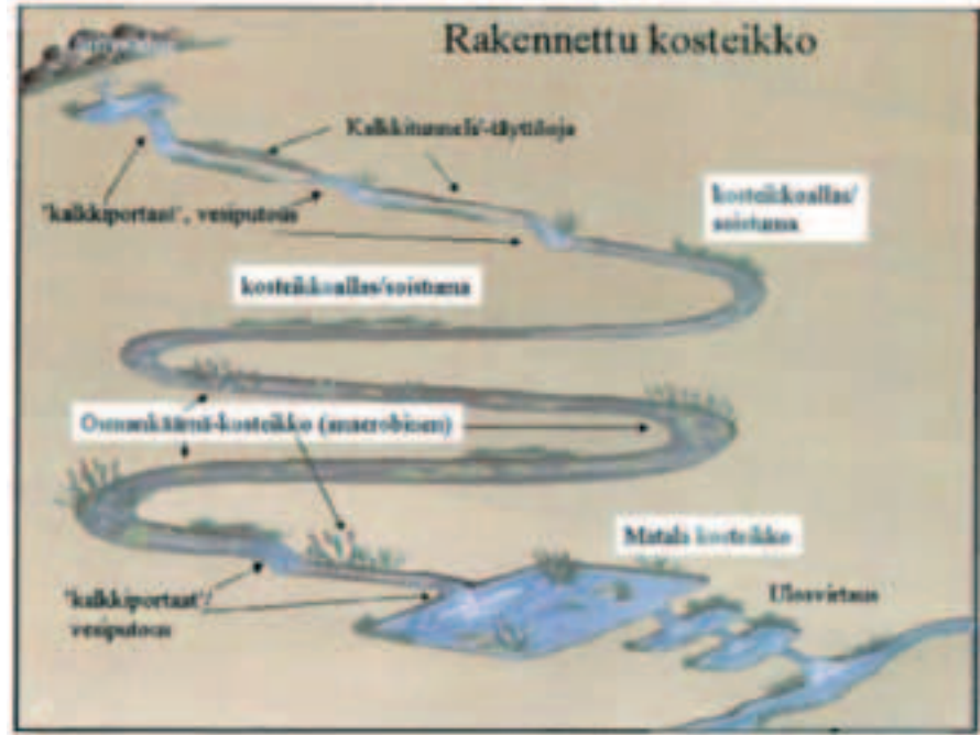
Kuva 1. Moniosainen rakennettu kosteikkosysteemi, jossa neutralointi veden neutralointi on toteutettu kalkkipadoilla. (Sengupta 1993 teoksessa Kytö & Räisänen 2002, 15.)
